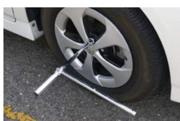
クロスバーを端に移動すれば少ない手力でゆるめ・締めができます。
